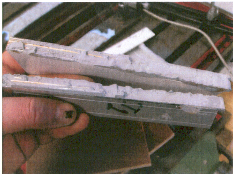
Foto 5.2.1 Fugemassen satt igjen på begge flatene etter testen for begge profiltypene
